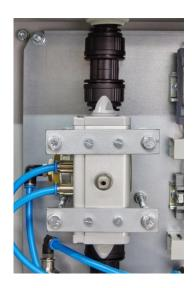
Zur Vermeidung des Ansaugdruckverlustes durch den Strömungswiderstand von Ventilen wird ein 1 Zoll 3-Wege-Kugelhahn höchster Qualität (FESTO) verwendet.
