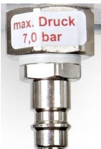
**2.3** Die Druckluft wird mit Hilfe der am Gehäuse unten liegender Schnellkupplung angeschlossen.
