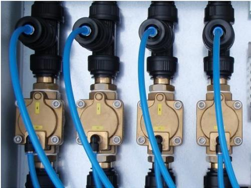
Zur Vermeidung des Ansaugdruckverlustes durch den Strömungswiderstand von Ventilen wird ein Einzoll Ventil höchster Qualität (FESTO) verwendet.
