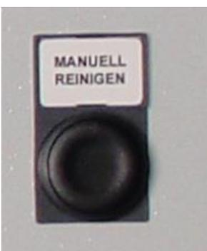
Die manuelle Reinigung zu Wartungszwecken kann durch Betätigung des Tasters „Manuell reinigen“ am Gehäuse erfolgen. Dabei wird ein kompletter Freiblaszyklus ausgelöst.
